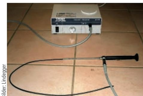
Mit einem Endoskop kann man den Motor auf schädliche Ablagerungen untersuchen.
