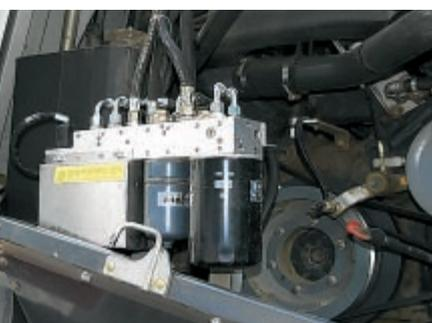
Der Ventilblock dient als Wärmetauscher und ist mit einem grossen Filter bestückt.
