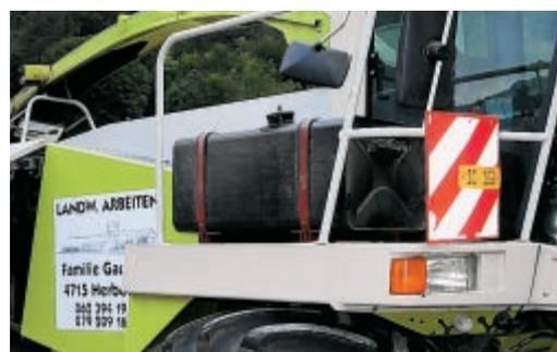
Beim Feldhäcksler stellt die Montage eines Zusatztanks für den Diesel kein grösseres Platzproblem dar.
