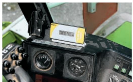
In der Kabine befindet sich die Bedienungseinheit mit Temperatur- und Füllstandsanzeige.
