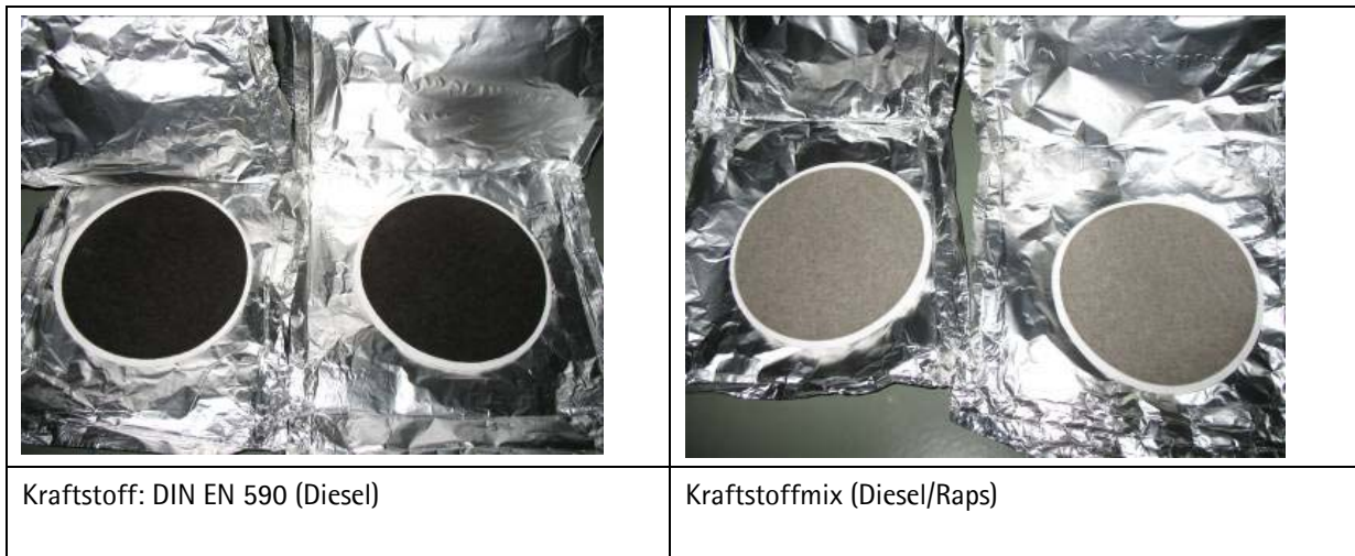
Abbildung 2: Beladene Filter nach der Probenahme (li. nach re.: Filter 1, 2, 5 und 7)
