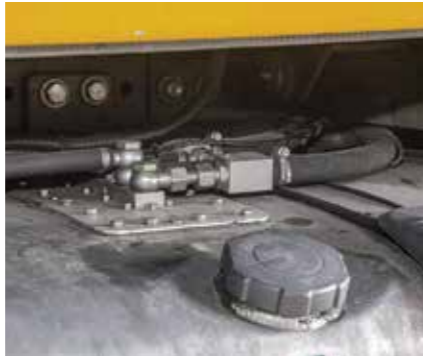
In den Biokraftstofftank ist eine Heizung eingebaut, die mit Kühlwasser gespeist wird. Das ist nötig, wenn Kraftstoffe wie z. B. Tierfette mit einem hohen Stockpunkt eingesetzt werden sollen.
