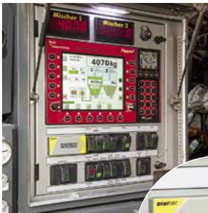
Die Bedienung für das Biokraftstoffsystem ist in der Bedienung der Mahl- und Mischanlage integriert.
