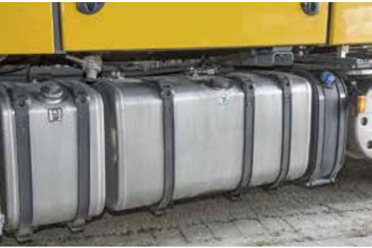
Eine 500-l-Tankfüllung Biokraftstoff reicht im Lohnunternehmen Feldevert-Höveler für ein bis zwei Tage. Diesel muss nur einmal wöchentlich in den 200-l-Tank nachgetankt werden.
