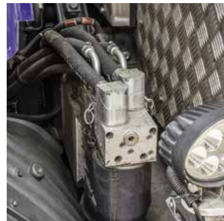
Ein Regelmodul mit Biokraftstoffpumpe, Filter, Sensoren und Magnetventilen für das Umschalten und ein elektronisches Steuergerät gehören zum Umrüstpaket von Biotec.
