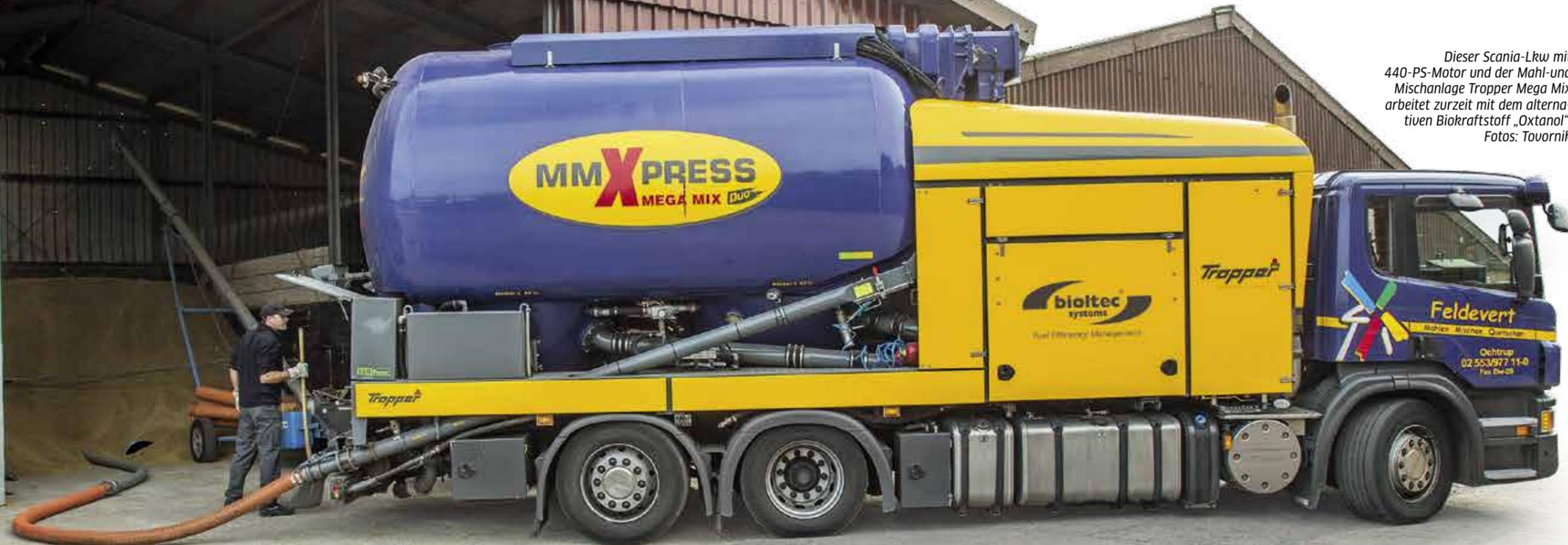
Dieser Scania-Lkw mit 440-PS-Motor und der Mahl- und Mischanlage Tropper Mega Mix arbeitet zurzeit mit dem alternativen Biokraftstoff „Oxtanol“. Fotos: Tovornik
