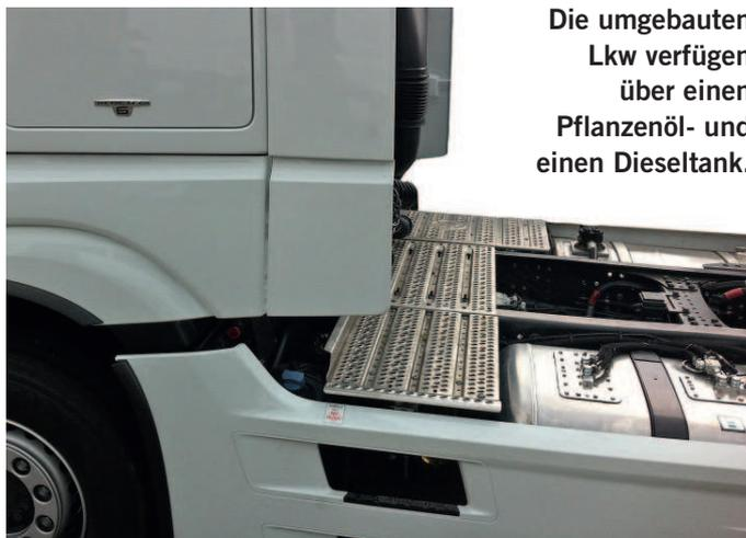
**Die umgebauten Lkw verfügen über einen Pflanzenöl- und einen Dieseltank.**
